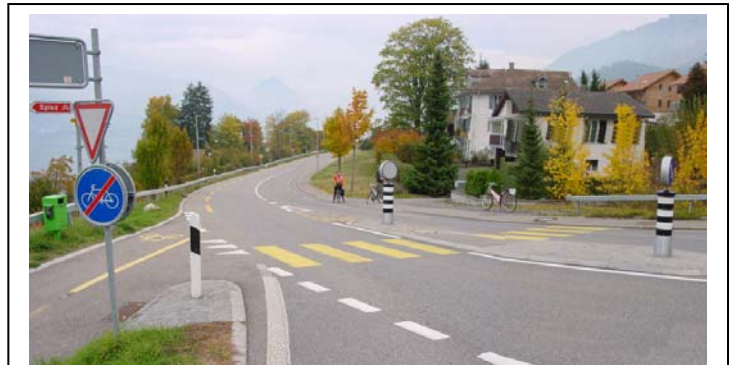
Molta attenzione è riservata alla risoluzione dei punti di conflitto: l'esempio di un incrocio tra la strada statale e il percorso ciclabile separato, con attraversamento pedonale protetto.
